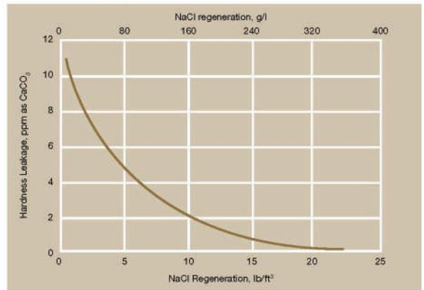
Las gráficas de Capacidad y Fuga de dureza se muestran asumiendo un caudal de servicio de 4 gpm/ft<sup>3</sup> y un máximo de 400 ppm de sólidos totales disueltos y 20 granos de dureza total. En el caso de producirse un aumento en los sólidos disueltos y dureza total del agua de alimentación, La fuga de dureza aumentará y la capacidad de intercambio disminuirá.
