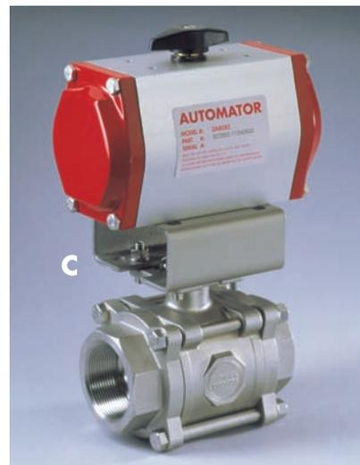
**Montaje seguro (C)** La brida superior fundida de manera integral garantiza un montaje positivo del actuador. El montaje seguro elimina el movimiento no deseado del actuador en las aplicaciones de funcionamiento continuo o de ciclos altos. El equipo del actuador puede quitarse de manera fácil y segura mientras la válvula se encuentra completamente sometida a la presión de la línea. Diseñada según los estándares del patrón de sujeción con pernos ISO 5211.
