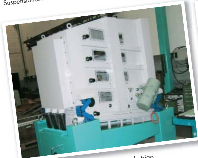
Suspensiones AB en planta de limpieza de trigo
