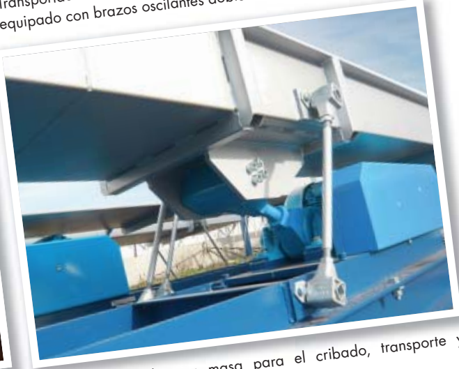
Transportador de dos masas equipado con brazos oscilantes dobles fabricados en fundición de aleación ligera
