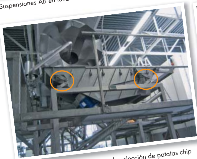
Suspensiones AB en lavadora-escurreadora de vegetales
