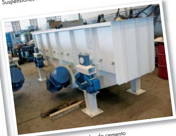
Suspensiones AB en alimentador de cemento
