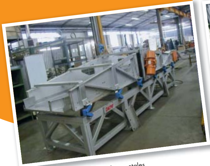
Suspensiones AB en lavadora de vegetales
