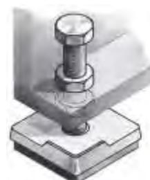
Si debemos nivelar la máquina, colocaremos el tornillo de nivelación sobre el hueco central del ISOCOL U.
