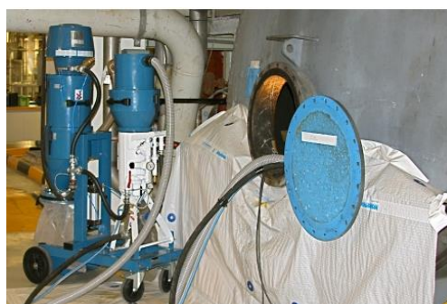
Limpia y despeja tanques y recipientes de forma segura, incluso en el interior (espacios confinados).
