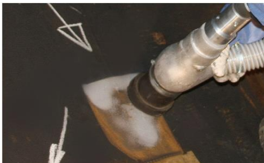
Limpia las estructuras y elimina los óxidos dañinos que se liberan durante la soldadura y el calentamiento.
