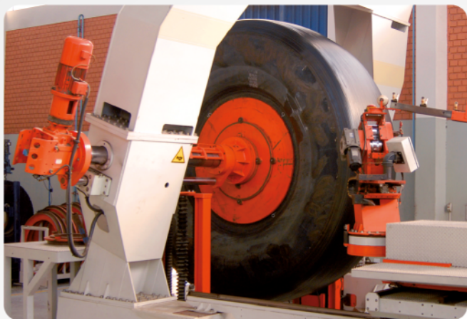
Desbaste y pulido de neumático con raspador CNC
