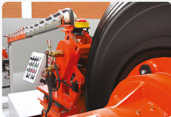
Aplicación de caucho con perfil computarizado
