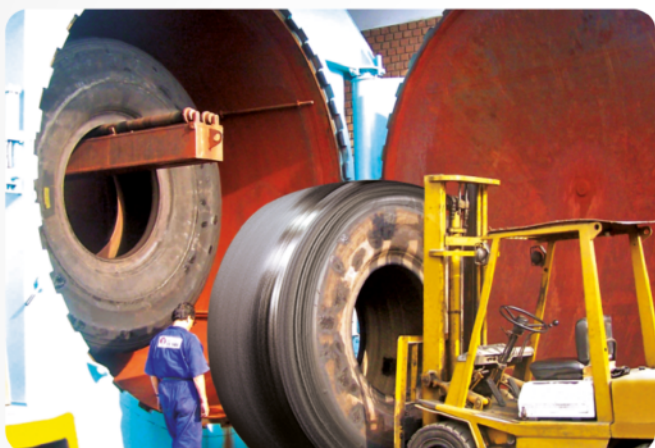
Vulcanización en autoclave con sistema de PLC computarizado
