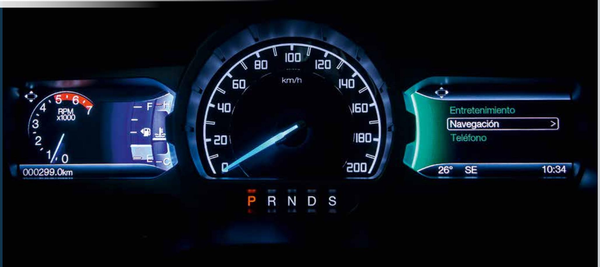
Dos pantallas LCD de 4,2" permiten visualizar y controlar los diferentes sistemas del vehículo sin necesidad de quitar las manos del volante.
