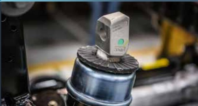
Reducen los niveles de vibraciones del motor en el arranque y la parada. Mejoran el confort en la conducción y reducen el temblor causado por las imperfecciones del camino.
