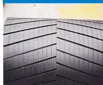
Tanque revestido en frío
