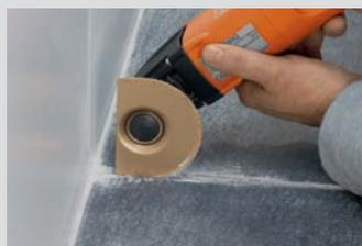
Cortar, raspar, sanear juntas, raspar: la versatilidad de aplicación ilimitada en obras en interiores y reformas.
