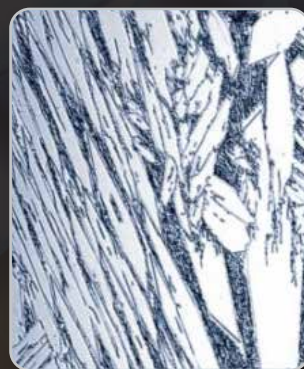
Muestra de ampliación x200 de la placa SA1750CR
