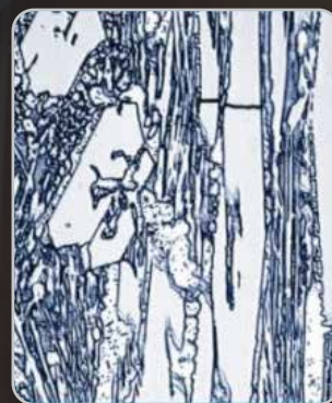
Muestra de ampliación x1000 de la placa SA1750CR
