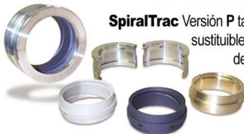
**SpiralTrac** Versión P también se ofrece con una inserción de ajuste sustituible que puede corregir la desviación del eje, además de eliminar los abrasivos del prensaestopas y prolongar la vida útil de la empaquetadura.
