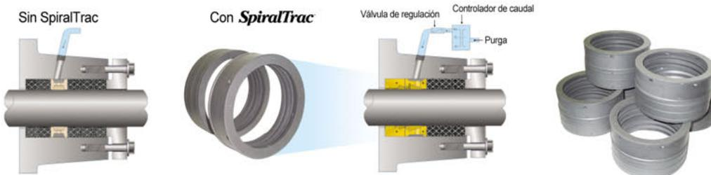
Reducción de las purgas - Para uso exclusivo con empaquetaduras - No requiere modificación de la bomba
