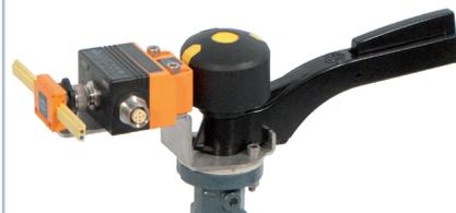
La conexión de bus de campo AS-I para válvulas manuales se obtiene mediante un sensor doble equipado con un conector de cable plano y dos sensores inductivos. Un "puk" indica la posición.
