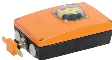
La caja final de Carrera SBU está equipada para AS-I como sigue: Dos micro sensores o sensores inductivos transmiten la posición de la válvula. Esta información es transmitida a través del cable de la interfaz, que también controla una electroválvula de bajo consumo energético (24V).
