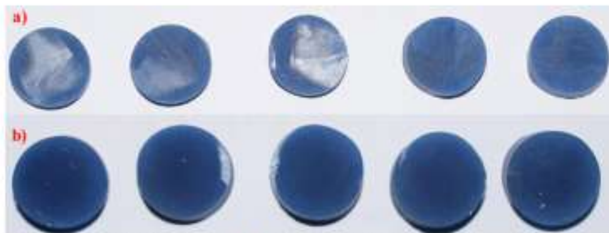
Figura 13 Muestras para ensayo de desgaste, a) antes de ensayo y b) después de ensayo.
