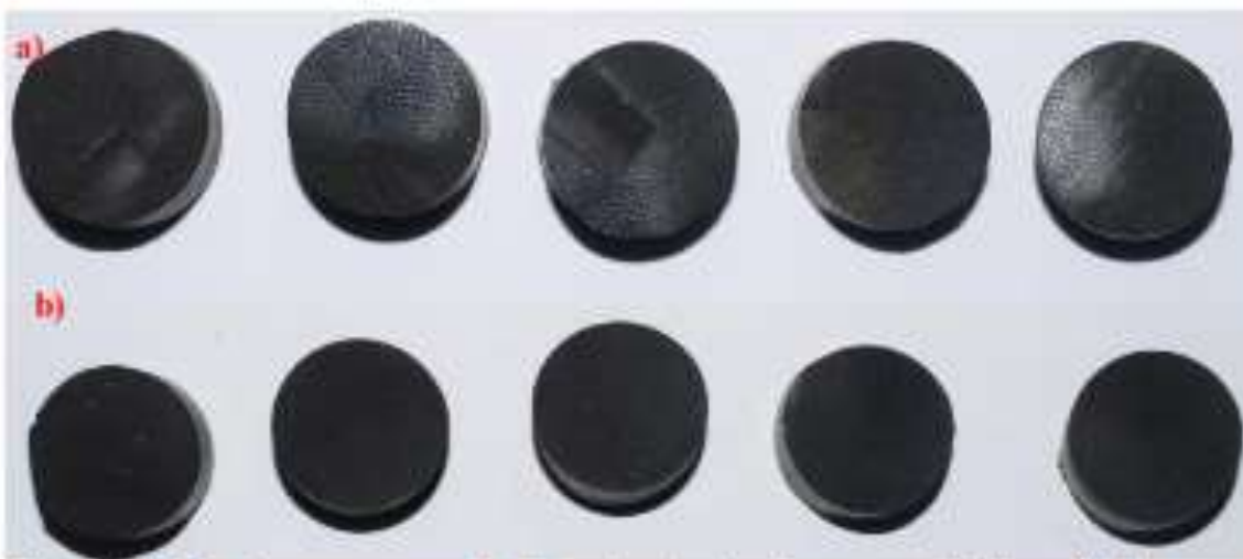
Figura 10 Muestras para ensayo de desgaste, a) antes de ensayo y b) después de ensayo.
