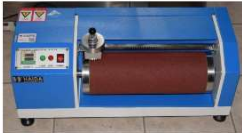
Figura 9 Equipo de desgaste abrasivo mediante tambor cilíndrico rotatorio.
