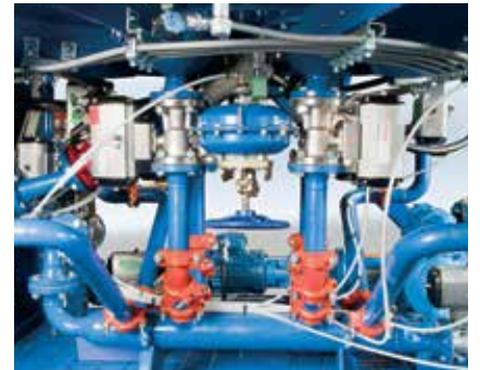
El SLR está equipado con un sistema de manejos de solución completamente automatizado
